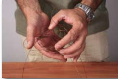
Déroulez quelques mètres de fil de fer recuit et regroupez dans vos mains pour former une boule
